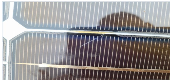
Figure 2. 4: Délamination sur la surface de la cellule
