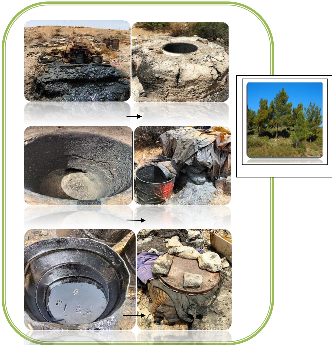
Fig 34 : Etapes d'extraction des huiles de cade (Dar Elbaydha 2018)
