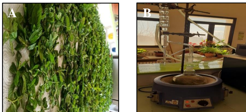
Figure 21. Séchage et hydrodistillation de M. spicata A : M. spicata ; B : Hydro distillateur (Photos personnelles).
