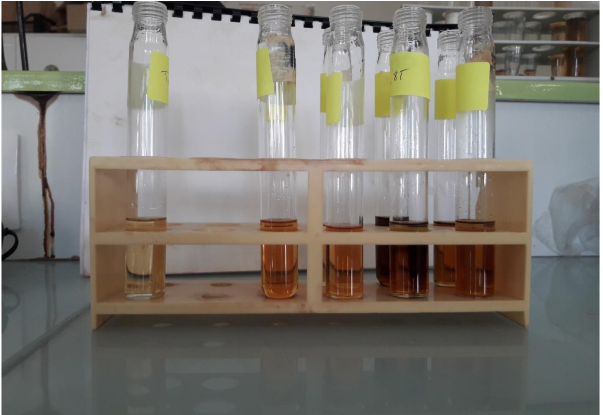
Figure 31: la coloration selon la concentration du glucose dans la solution à analyser.
