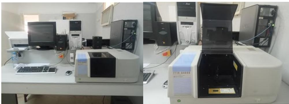
**Figure 17. Spectromètre IR à transformée de Fourier (FTIR - 8400S - SHIMADZU).**
