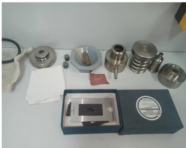
**Figure 22. Matrice à presse hydraulique pour la preparation des pastilles.**
