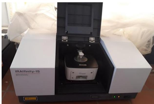
**Figure 18. Spectromètre IR à réflexion totale atténuée (ATR - IRAffinity - 1S - SHIMADZU).**
