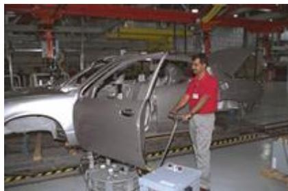
*Fig. I.20 : Un déchargeur de porte au sol développé par l'Université Northwestern est testé dans une usine GM [55]*
