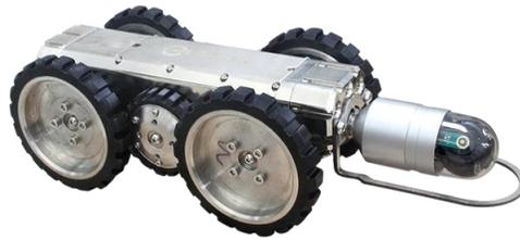
*Fig.I.10 : Un robot éliminant les obstacles dans les égouts [41]*
