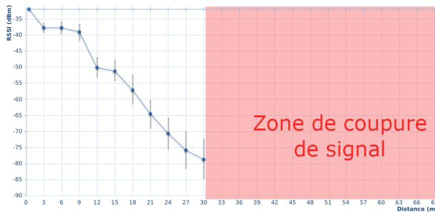
*Fig. II.9 : RSSI en fonction de la distance, la technologie ZigBee*
