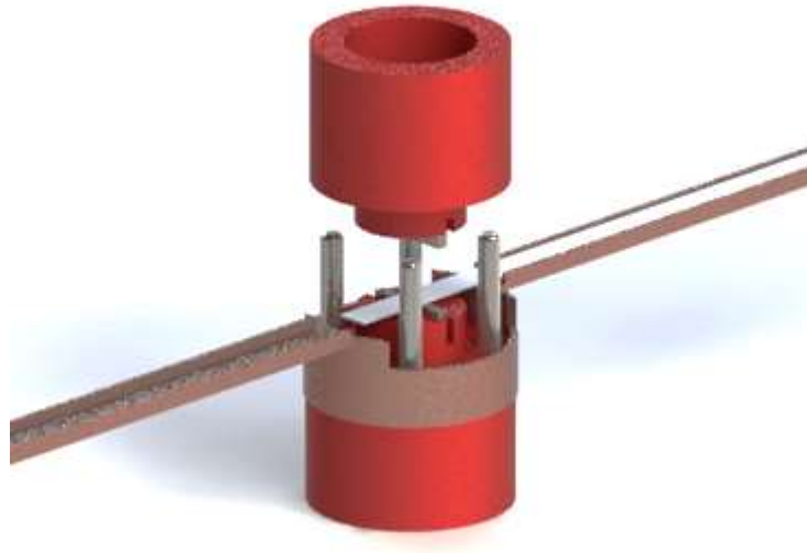
Figure 3.7 : Vue générale de l'ensemble portes-poinçons et porte-échantillon.
