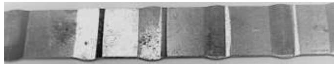
Figure 4.7 : Présentation de l’état de la tôle après écrasement du matériau écroui
