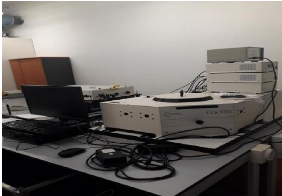
Figure 4-5 : dispositif expérimental utilisé pour les mesures de luminescence.
