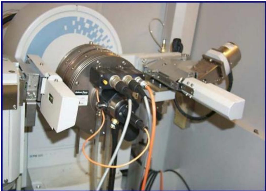
Figure 4-2 : Chambre à haute température Anton Paar HTK 1200.
