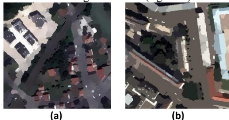
Figure 2. Résultat de segmentation Meanshift, (a) image 3 h^s=13 , h^r=12 et Minreg=30 , (b) image 30 h^s=11 , h^r=12 et MinReg=3
