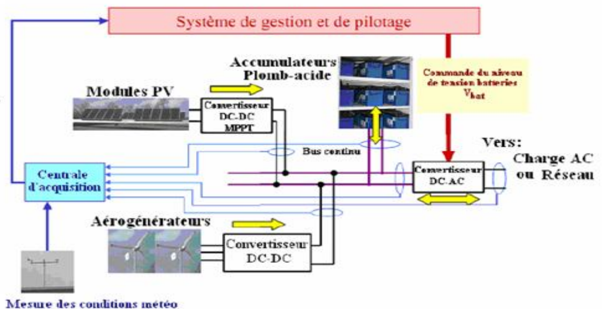
Figure 1.14. Synoptique d'une installation expérimentale-système de production hybride PV/éolien associé au stockage de l'énergie
