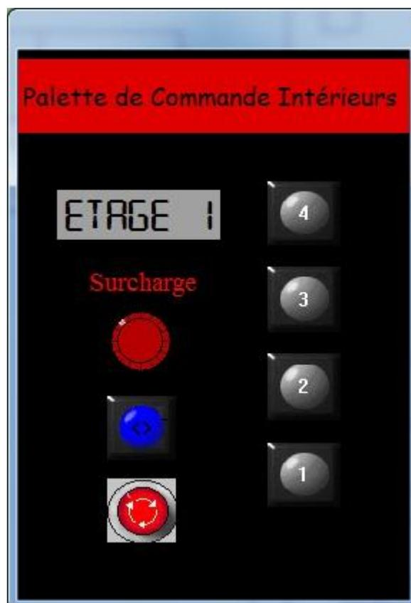
Figure 3-12 : un afficheur intégré à la palette de commande intérieure
