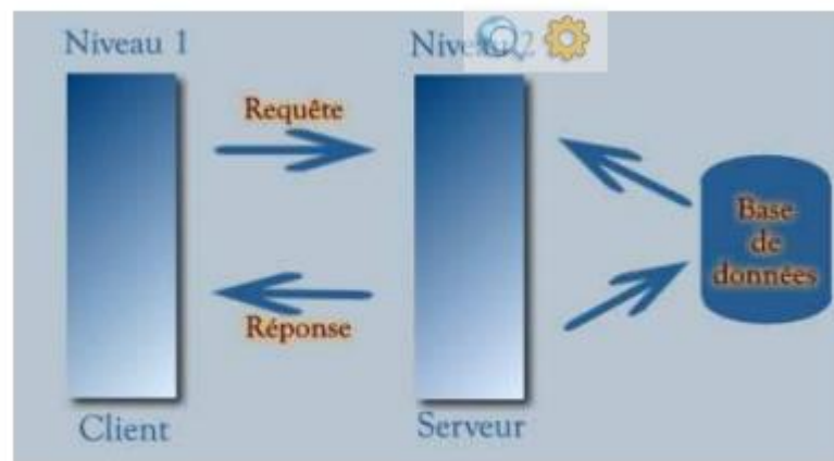
Figure 2-10 Architecture à deux niveaux
