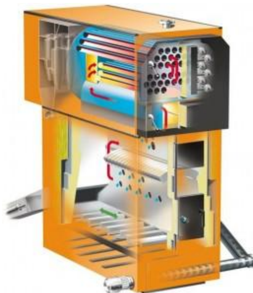
Figure 1-5: chaudière à foyer
