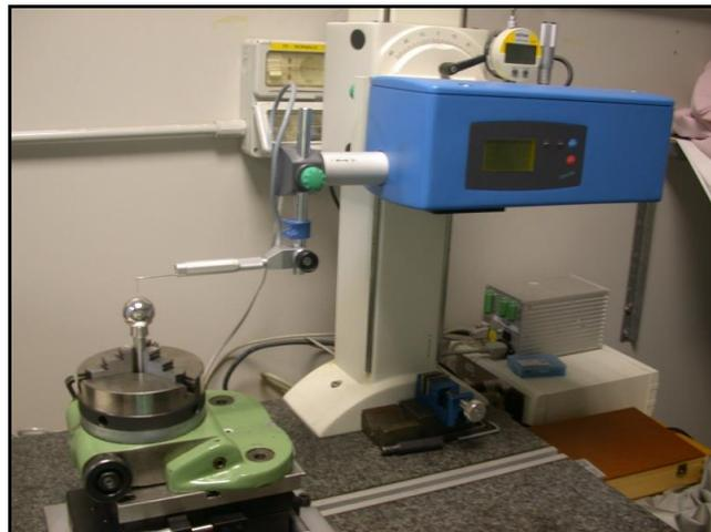
**Figure 3.4a** : Rugosimètre Hommel Tester 8000[IHAD07].
