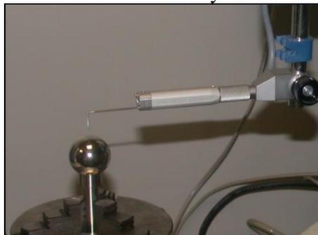
**Figure 3.4b** : Tête en diamant du rugosimètre.
