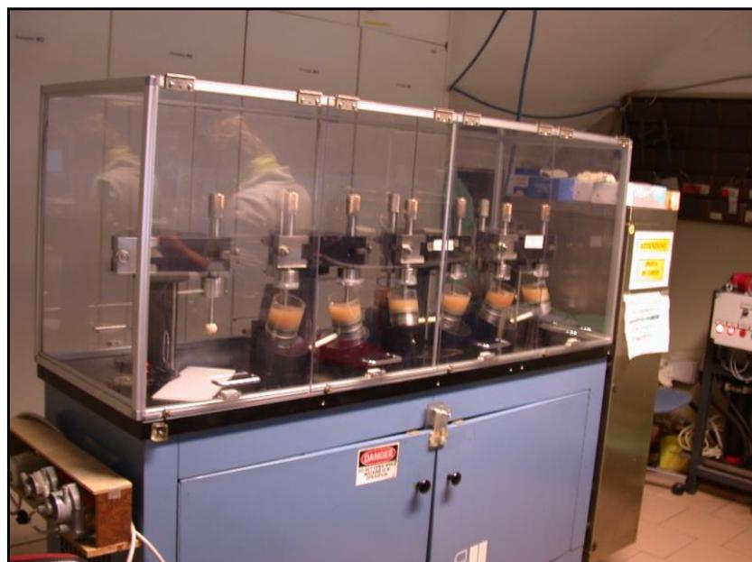
**Figure 3.2:** Simulateur de hanche utilisé.
