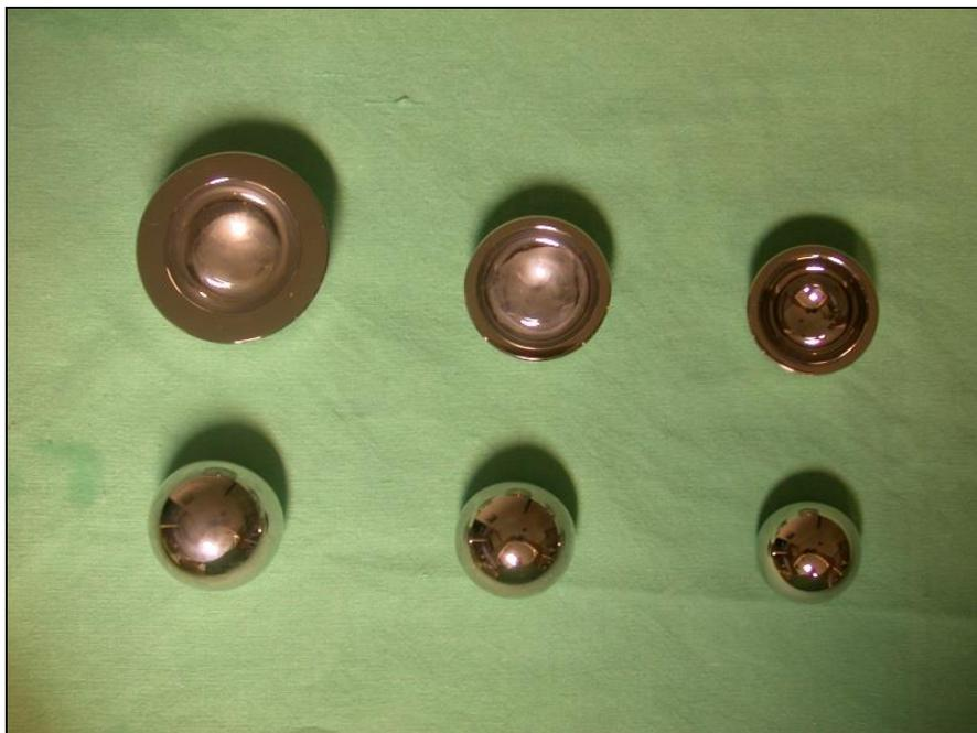
**Figure 3.1:** Les composants des différents couples Métal/Métal de 28, 32 et 36 mm de diamètre.
