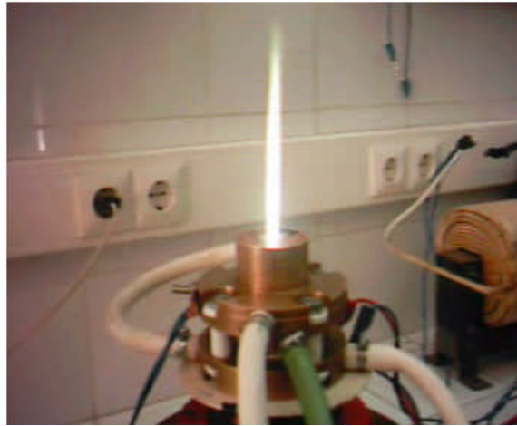
Figure 3.31. Photo - Développement du jet de plasma de la torche
