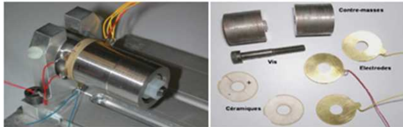
Figure 1.14 Vue éclatée et assemblée d'un moteur à rotation de mode
