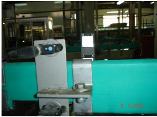
Figure 2.13. Capteur photocellule d'accumulation
