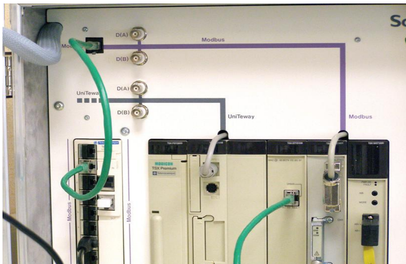
Figure 3.19 Raccordement du module SCY 21601 au répartiteur Modbus.
