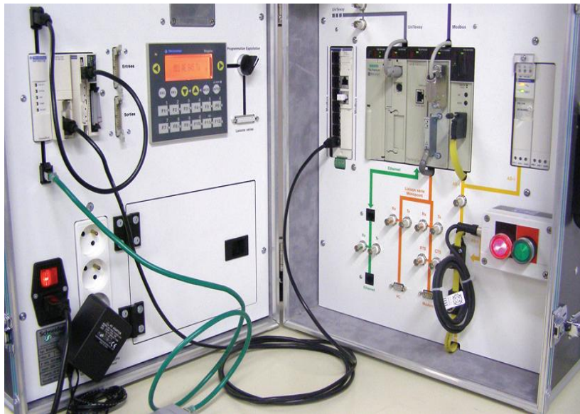
Figure 3.18 Raccordement du Twido au répartiteur Modbus.
