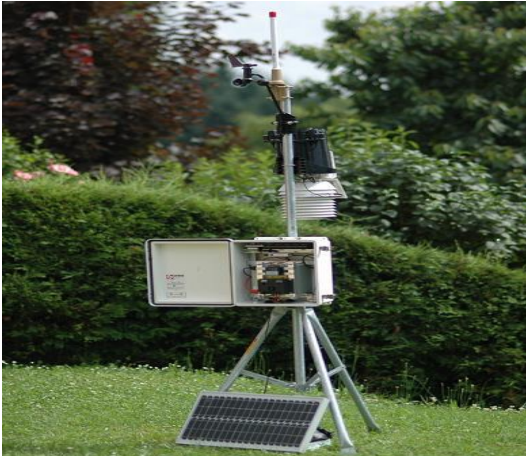
Figure 7. Station météo autonome avec transmission par GSM DATA
