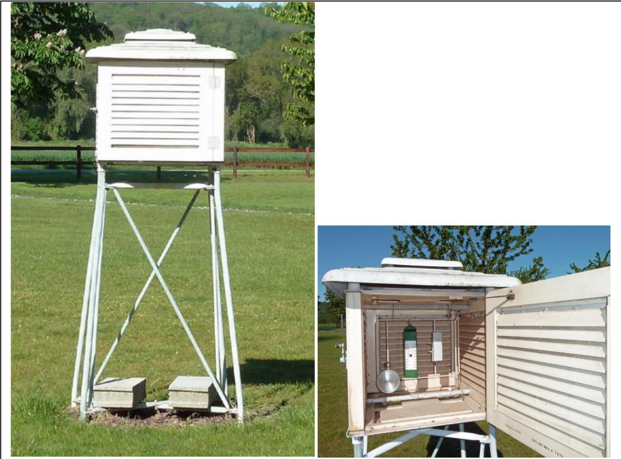
Figure 6. Abri météorologique de STEVENSON
