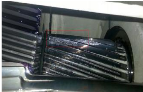
Figure 1.6 : Défauts d'usures d'engrenages [21]
