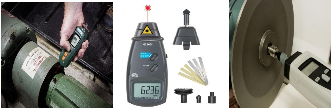
Figure 3 : principe de fonctionnement d'un tachymètre optiques [34]
