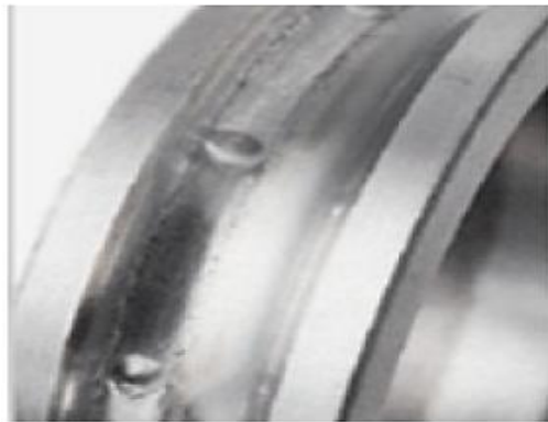
Figure 1.12 : Déformation plastique de la surface d'un roulement [35]
