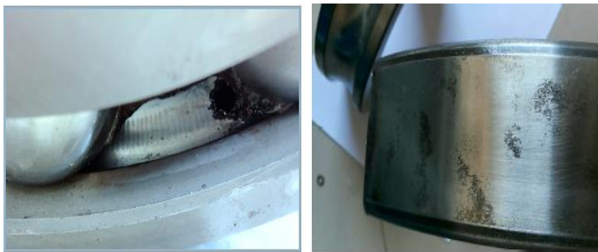
Figure 1.14 : Défaut d'érosion électrique d'un roulement d'éolienne [40].
