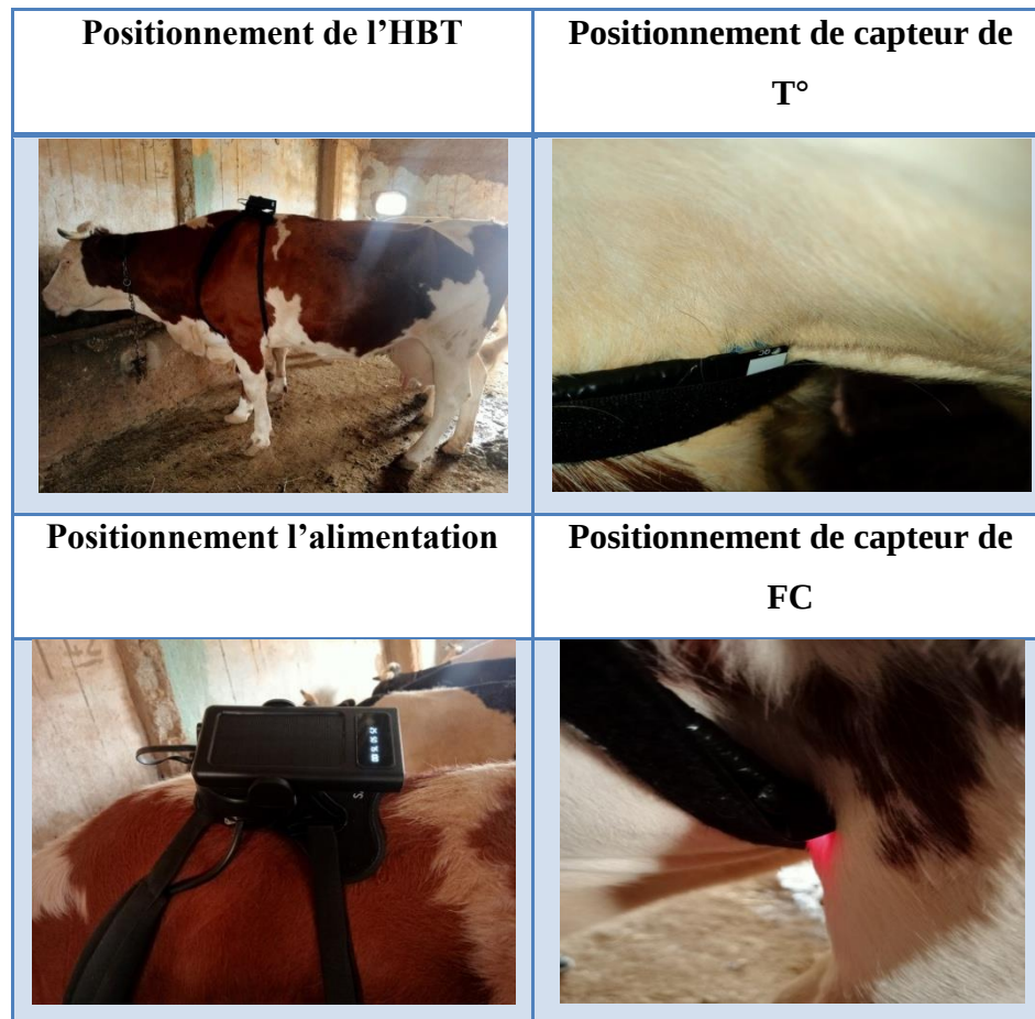
Figure 43: la mise en place de l'HBT sur une vache
