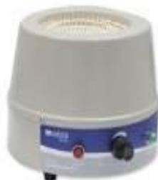
**Chauffe ballon** : permet de chauffer les ballons. sur la surface demi-sphère. Il est utilisé pour les montages, notamment à reflux.
