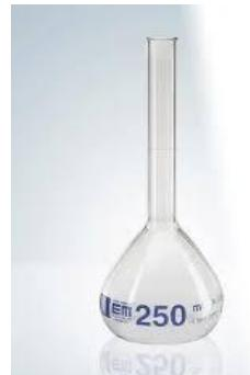
**Fiole jaugée :** permet de mesurer un volume liquide avec une bonne précision, utilisée pour la préparation des solutions.
