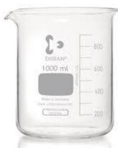
**Bécher :** utilisé pour transvaser une solution d'un flacon, sert pour le dosage des espèces titrées. Il peut être chauffé s'il est en pyrex. Ses graduations ne sont que d'ordre indicatif.
