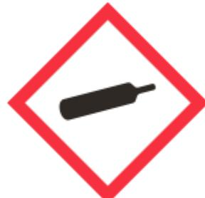
**Bouteille à gaz** (pour les gaz sous pression)
