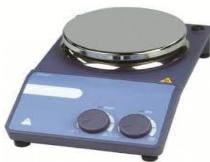
**Plaque chauffante agitatrice** peut simultanément chauffer uniformément et mélanger les solutions.
