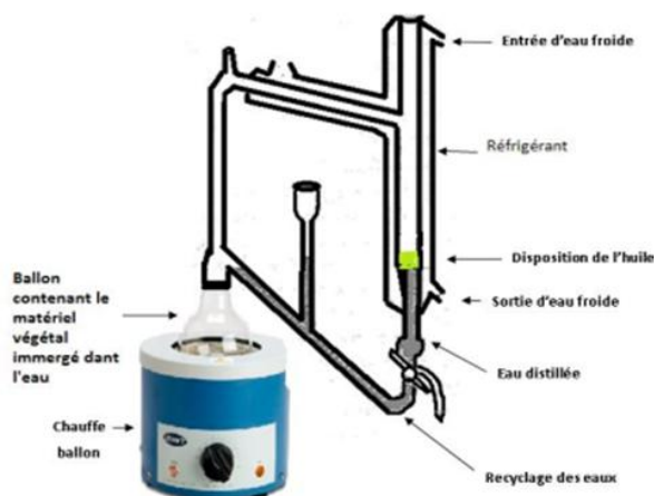
Figure 20 : Extraction des huiles essentielles par hydrodistillation (Clevenger)
