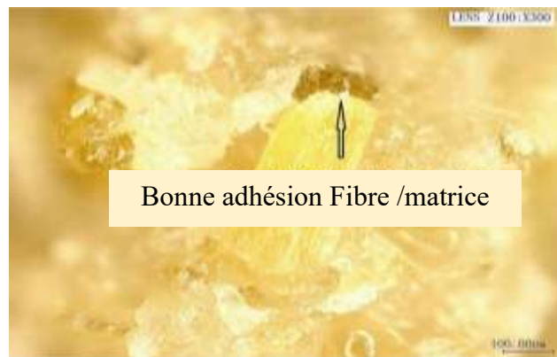
Figure I.3 Micrographies des surfaces des composés BP/PLA : traités par une solution de NaOH pendant 3 heures [29].
