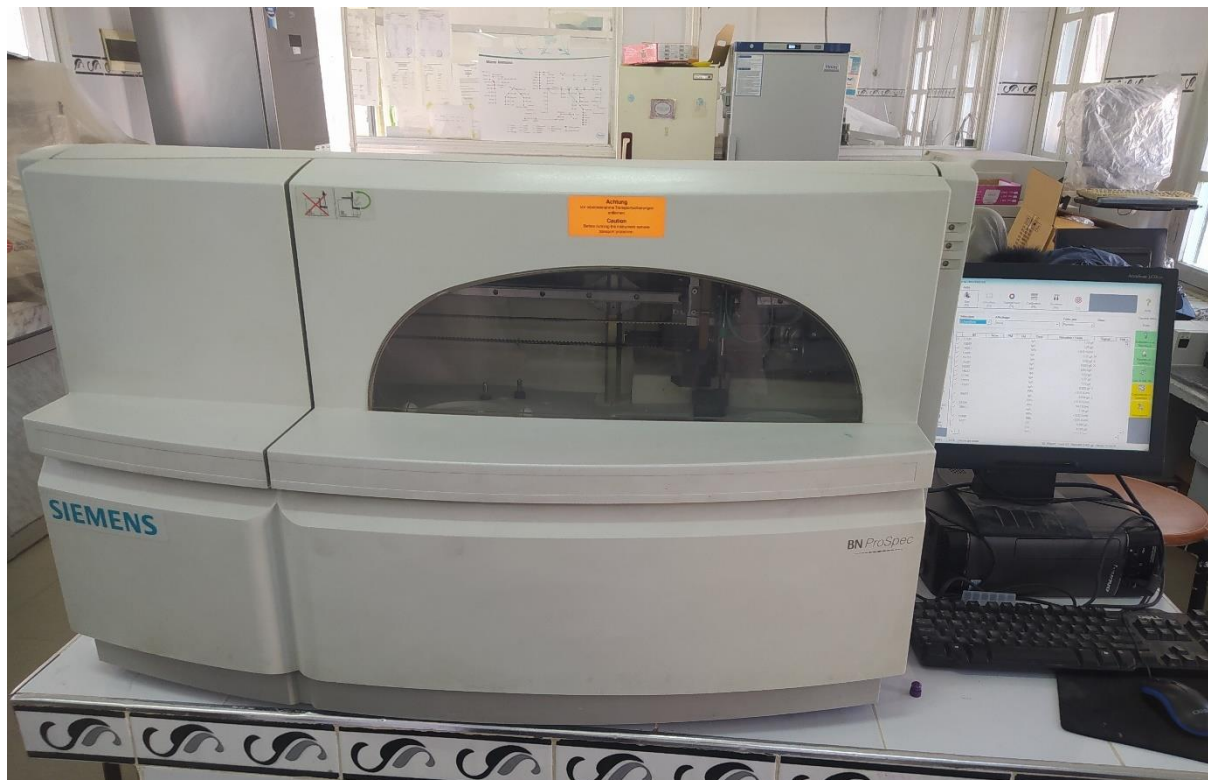
Figure 28: Automate laser-néphélomètre BN ProSpec ( Siemens Healthcare Diagnostics, Allemagne ).
