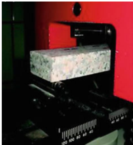
Figure 1. 13 Photo du dispositif expérimental pour la détermination de la résistance à la flexion [30]
