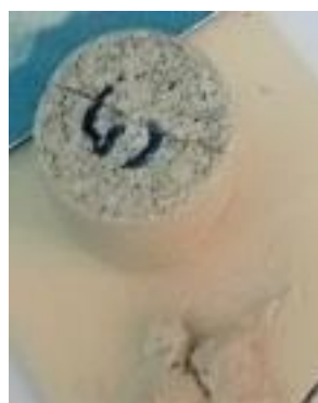
Figure V.17 : Ruine de rupture de l'échantillon fritté à 1400°C pendant différentes durées
