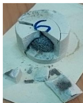
Figure V.16 : Ruine de rupture de l'échantillon fritté à 1300°C pendant différentes durées
