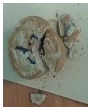
Figure V.17 : Ruine de rupture de l'échantillon fritté à 1400°C pendant différentes durées
