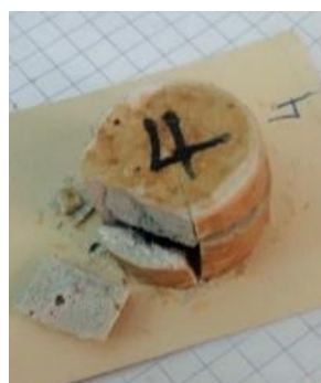
Figure V.16 : Ruine de rupture de l'échantillon fritté à 1300°C pendant différentes durées
