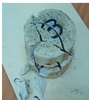
Figure V.16 : Ruine de rupture de l'échantillon fritté à 1300°C pendant différentes durées
