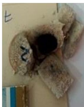
Figure V.17 : Ruine de rupture de l'échantillon fritté à 1400°C pendant différentes durées
