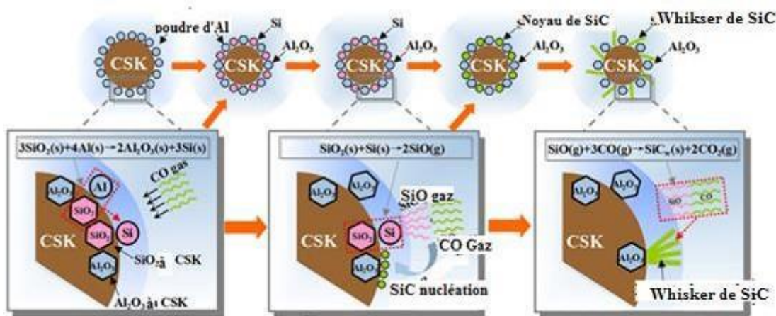
Figure II.18 : Illustration de la réduction carbothermique assistée par l'aluminium [Lao 20]
