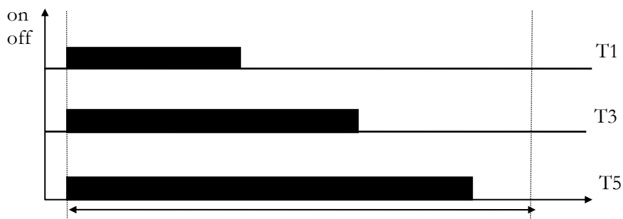
Figure 6-6: Les états des interrupteurs du pont alignés
