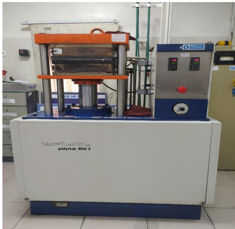
Figure 4.2: Photographie numérique de la presse Polystat 300S.
