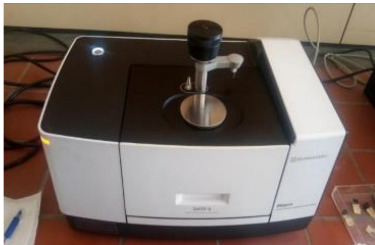
Figure 4.9: Image Spectromètre Infrarouge FTIR SHIMADZU QUATR-S.
