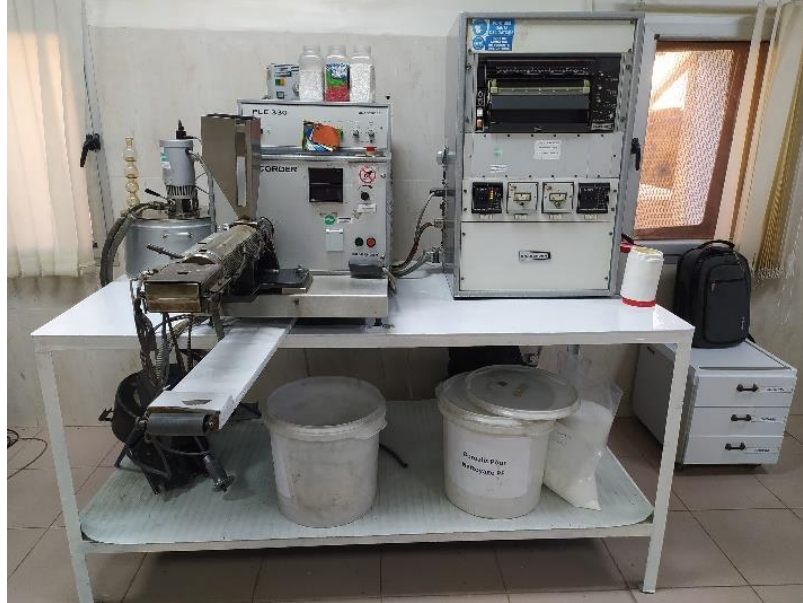
Figure 4.1: Photographie numérique de l'extrudeuse mono-vis Brabender PLE 330.
