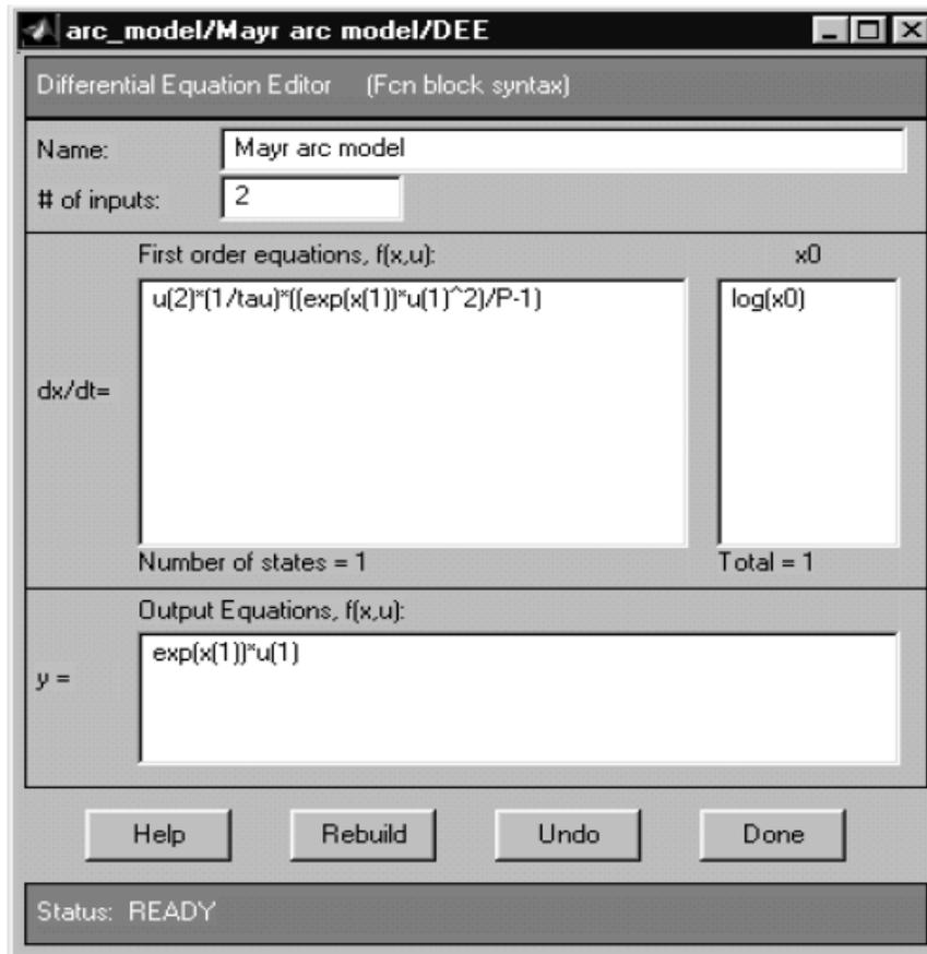
**Figure 7.4. Incorporation des modèles d'arc dans l'ancien AMB à l'aide du block DEE de Simulink/PSB [65]**
