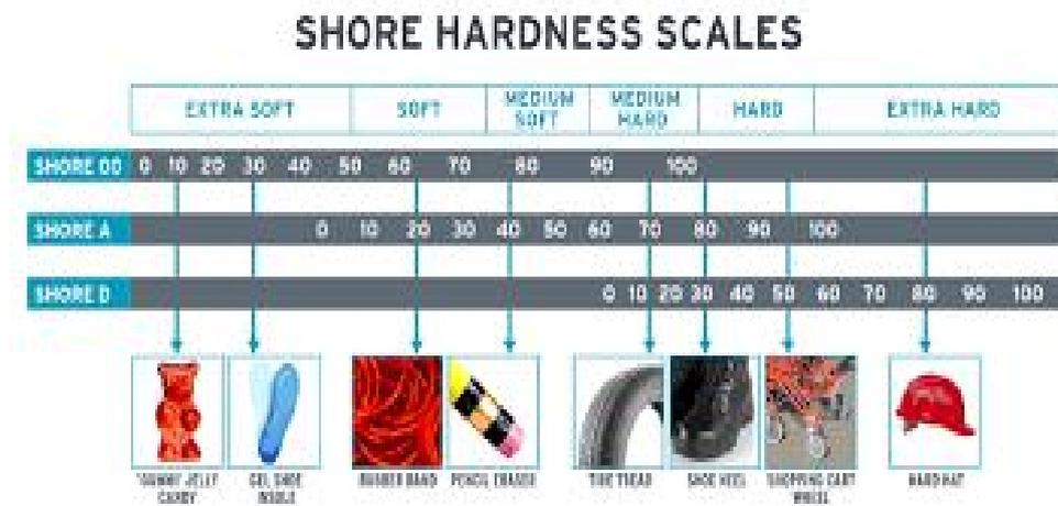
Figure II.13 : Les échelles les plus courantes pour mesurer la dureté
