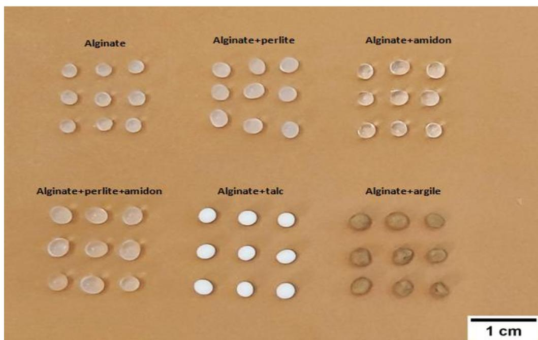
**Fig.26.** Image des capsules fabriquées d'alginate et de différents mélanges d'additifs.
