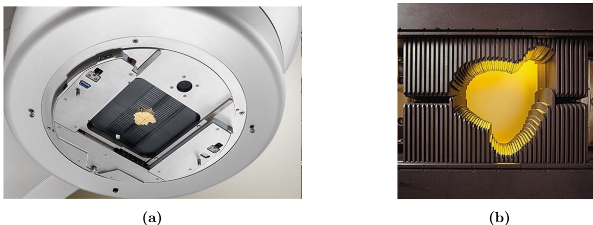
Figure 2.8 – Tête de l'accélérateur (a) et le collimateur multilame (b).
