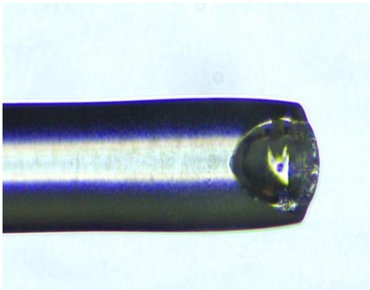
Figure IV-23: microcavité et microlentille PMMA a l'extrémité de la fibre
