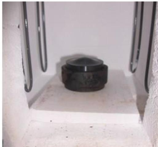
Figure III-17 : Moulage de la lentille.
