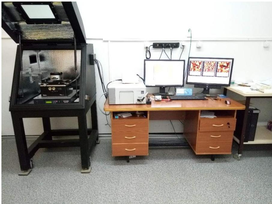
**Figure 3.8.** Microscope à force atomique (AFM) conventionnel de modèle MFP 3D
