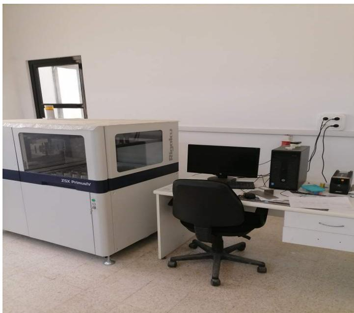
**Figure 3.7** : Le spectromètre de fluorescence des rayons X (XRF)
