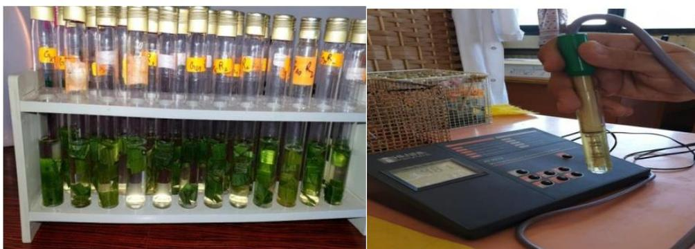
**Photo 3 :** Echantillons de feuilles placées dans des tubes à essais remplis de 10 ml d'eau distillée (à gauche) et mesure de leurs conductivités (à droite).
