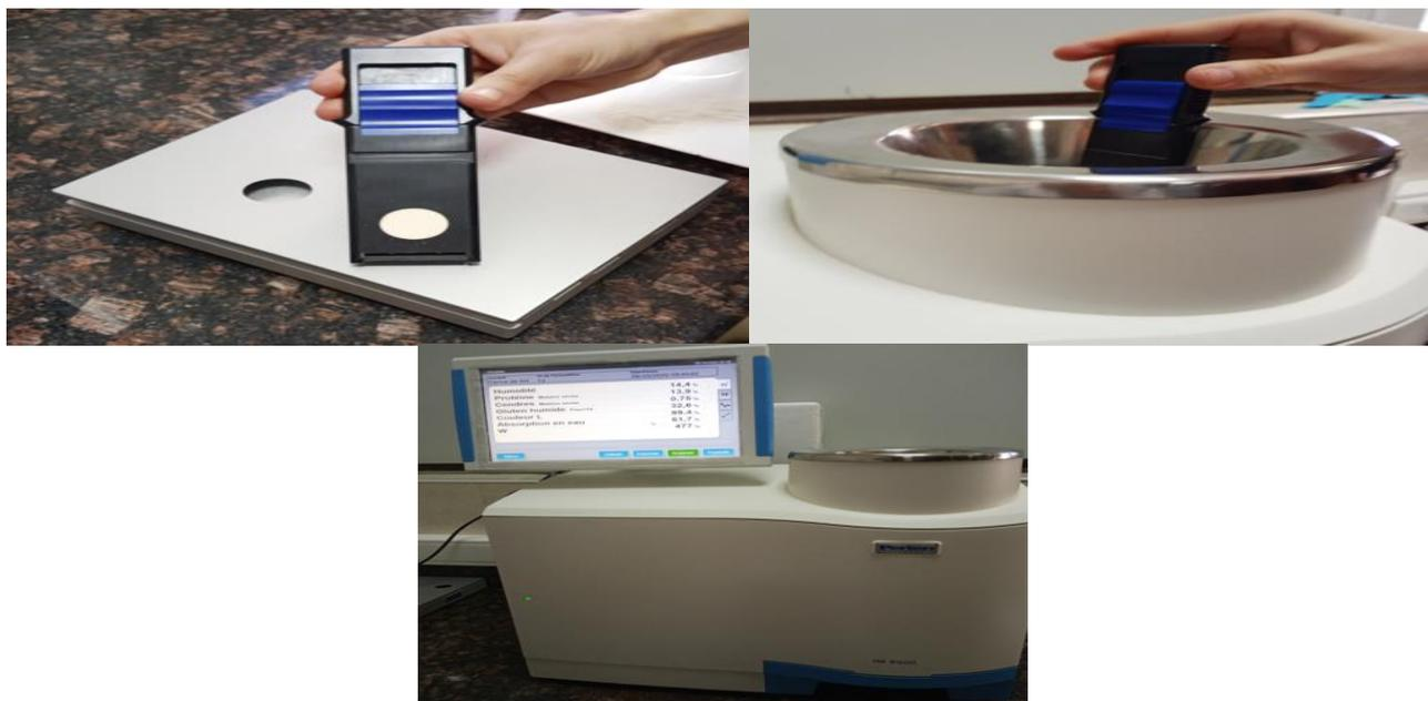
**Photo 7 :** L'INFRAMATIC de type PERTEN utilisé pour évaluer la qualité des farines de blé.
