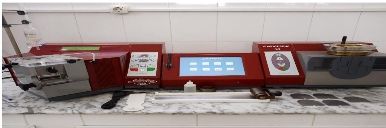
**Photo 8 :** l'alvéographe de Chopin utilisé pour déterminer les paramètres rhéologiques de la farine de blé.
