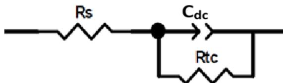
**Figure V. 8:** Circuit équivalent de l'interface de l'acier F10 avec le milieu d'étude
