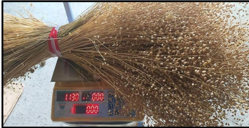
Figure 13 . La pesée d'une biomasse d'un mètre carré
