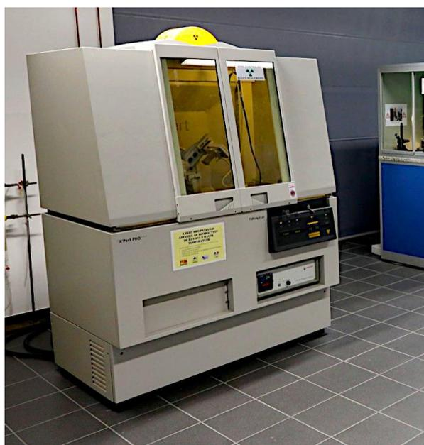
**Figure III.8 :** Diffractomètre à rayons X PANalytical X'Pert PRO
