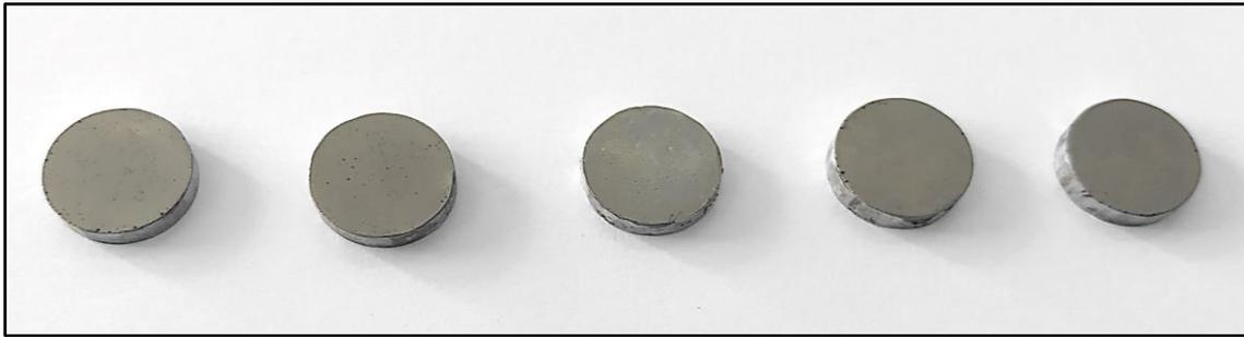
**Figure IV.1 :** Photographie des dépôts de nickel électrodéposés sur des substrats Al-5Mg
