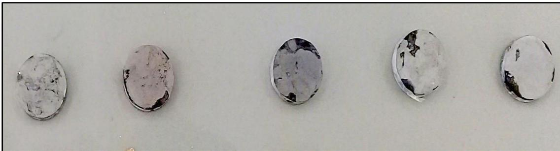
**Figure IV.2 :** Photographie des dépôts de nickel obtenus sous des conditions dépassant les valeurs optimales
