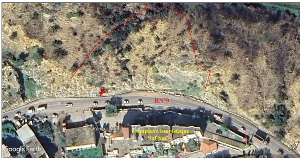
Figure 5.2 : Implantation du scanline sur le talus rocheux en face de l'Hôtel Safsaf
