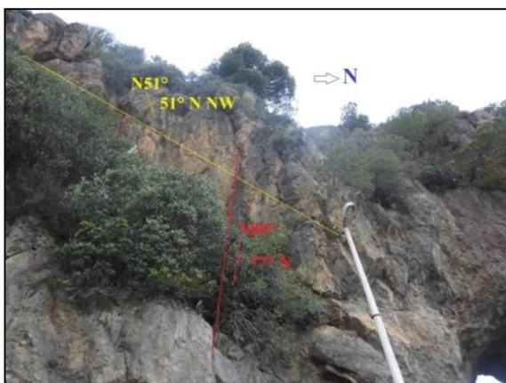
**Figure 4.18** : F2 visible sur le versant Est
