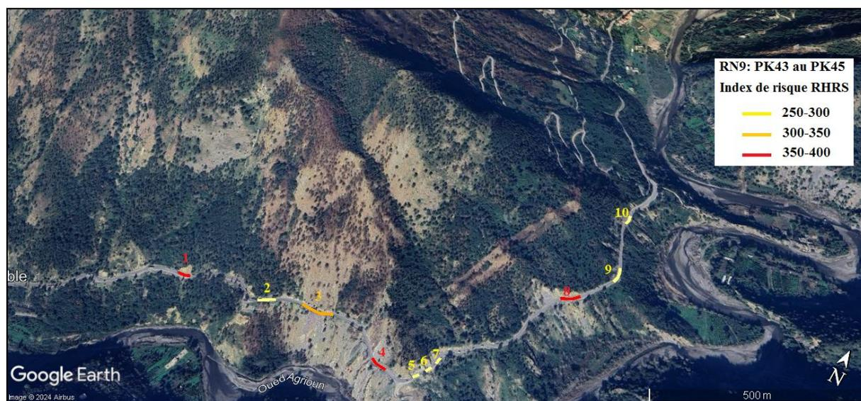
**Figure 7.19** : Cartographie du risque hiérarchisé de chute de blocs en talus le long de la RN9
