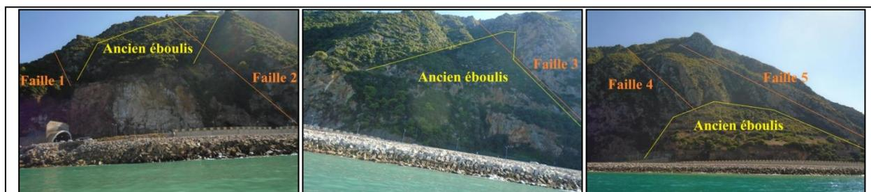
**Figure 4.10 :** Anciens éboulis localisés entre les failles dans les zones de broyages
