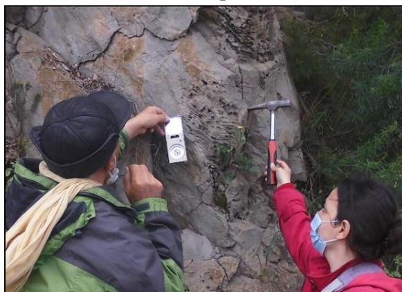
**Figure 4.8** : Structure laminaire  $N40^\circ < 62^\circ$  N-NW
