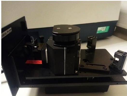
**Figure 44.** – Sphère intégrante associée au spectrophotomètre Jasco 600
