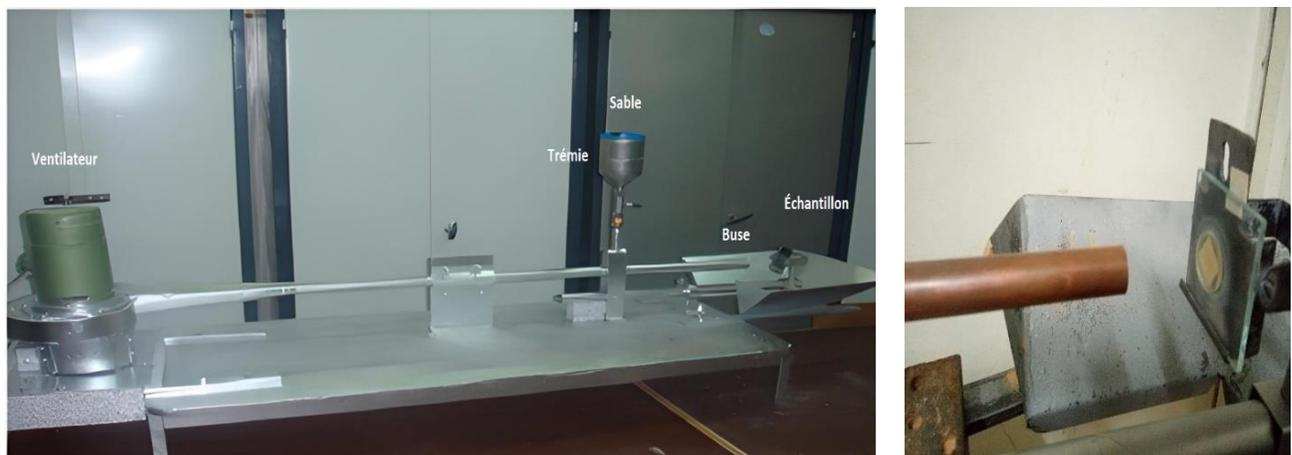
**Figure 54.** – Dispositif de sablage utilisé
