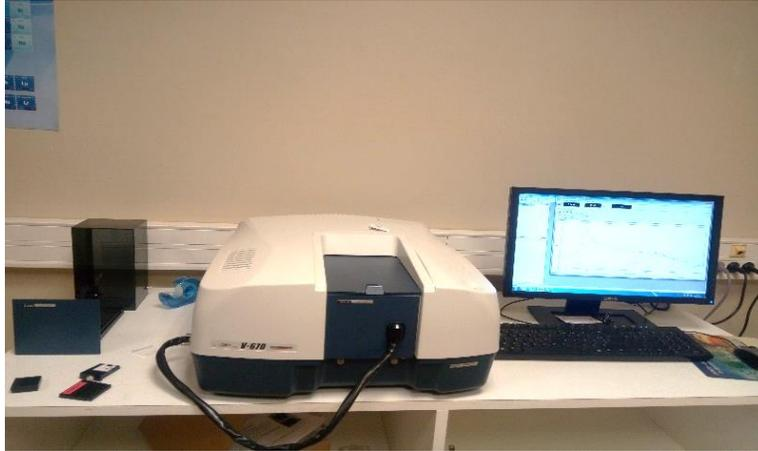
**Figure 42.** – Spectrophotomètre (UV-Vis/NIR V-670, Jasco).
