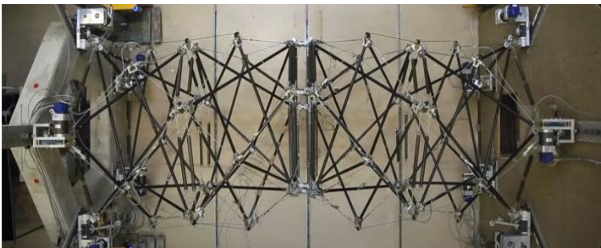
Fig 1.13. Maquette à échelle réduite de la passerelle de tensegrité déployable étudiée dans [20–21].
