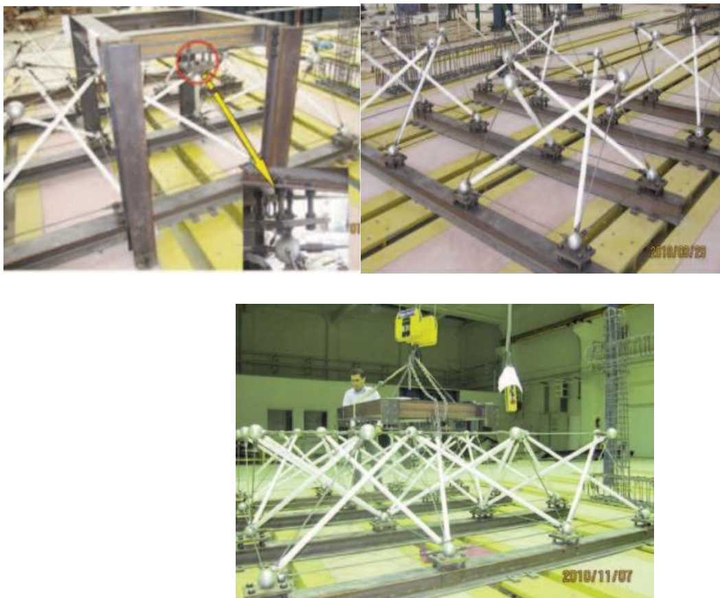
Fig 3.8. La séquence de construction de la tensegrité modèle. (a). Fixation de quatre modules d'angle à la plate-forme (b). Construction des bords du modèle sur plate-forme à l'aide d'un gabarit (c). Construction du module central du modèle à l'aide d'un gabarit.
