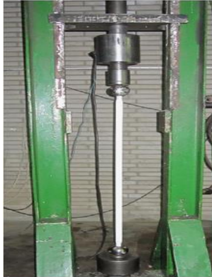
Fig 4.6 Essai de flambement sur une barre [86].
