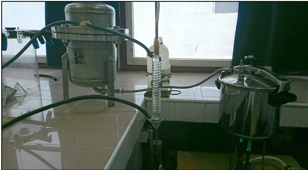
Figure 19 : Dispositif d'extraction d'huile essentielle de type clavenge
