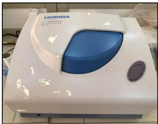
Figure 21: Dispositif du DLS utilisé pour l'analyse de la taille et la charge des particules de la nanoémulsion et nanoencapsulation
