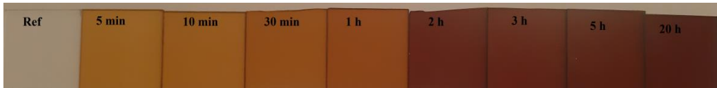
Figure IV.24 Évolution de la coloration du verre échangé avec l'augmentation du temps d'échange à T=350^{\circ}\text{C} après un recuit de 1 h à T=500^{\circ}\text{C}
