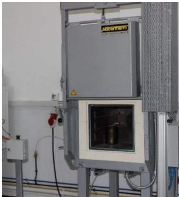
Figure III. 2 Four électrique programmable (marque Nabertherm) pour l'échange ionique.
