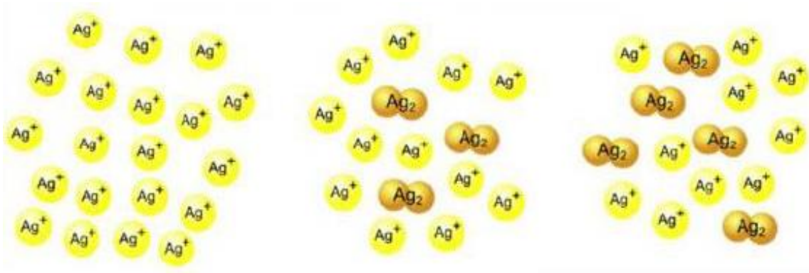
Figure I.9 Incorporation des ions \text{Ag}^+ dans la matrice vitreuse
