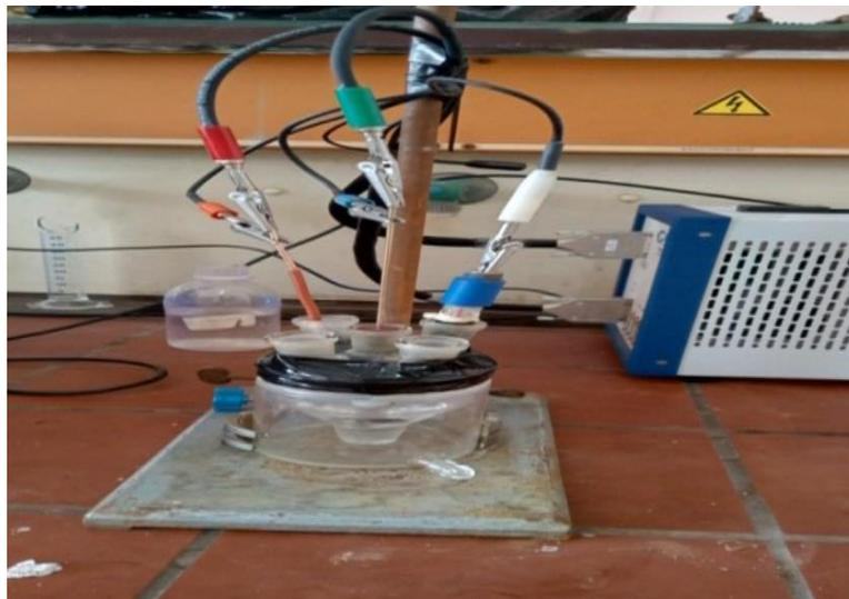
**Figure II.9 :** Cellule électrochimique
