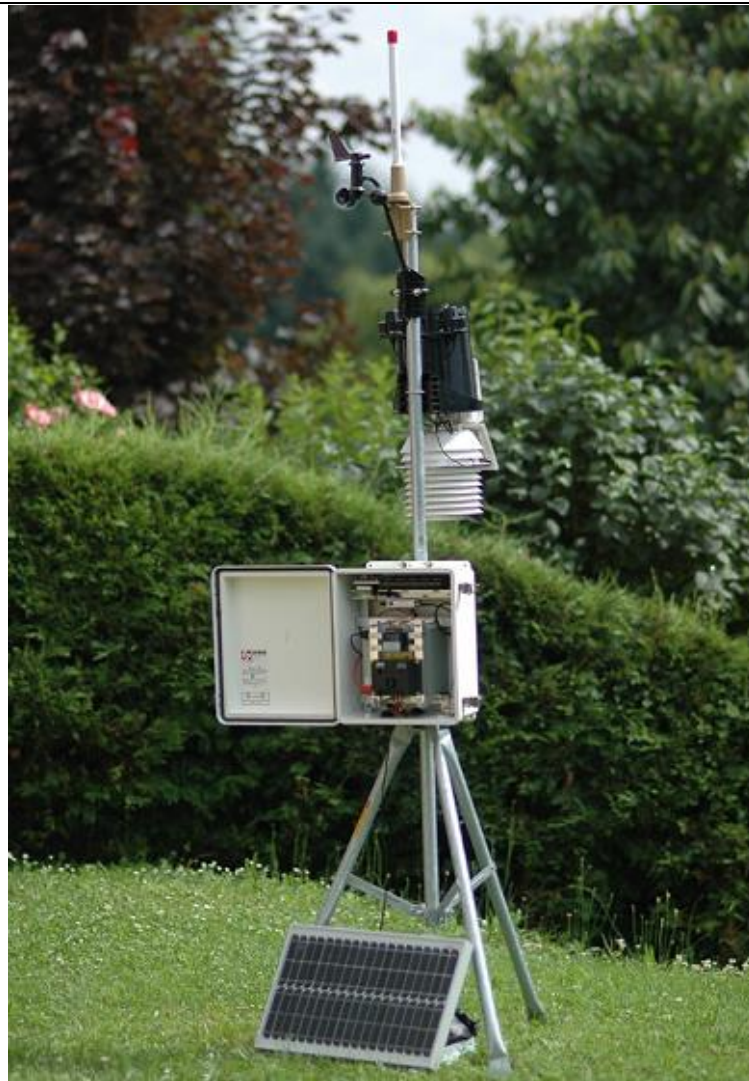
Figure 2. Station météo autonome avec transmission par GSM DATA
