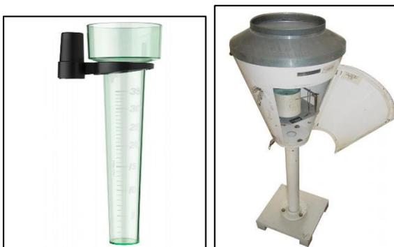
Figure 10: Appareils de mesure des précipitations
