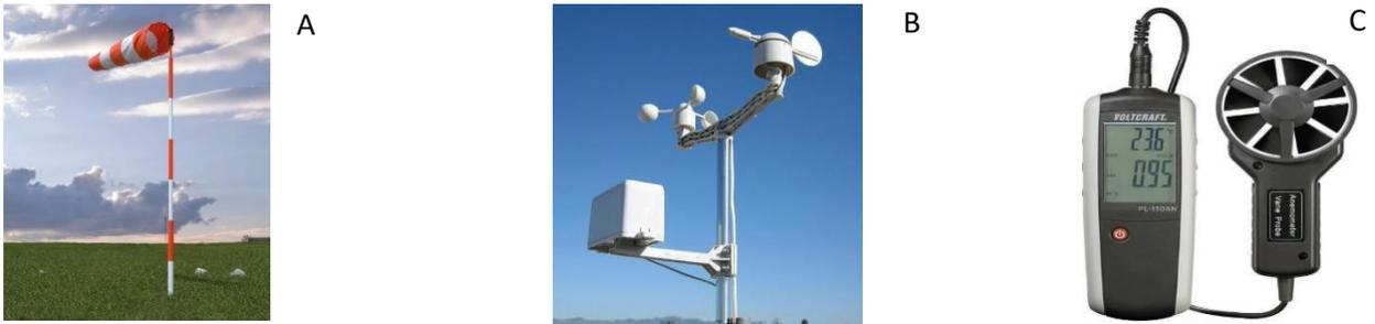
Figure 17: Instruments de mesure du vent/ A: Manche à air; B: Anémomètre avec girouette; C: Anémomètre électronique
