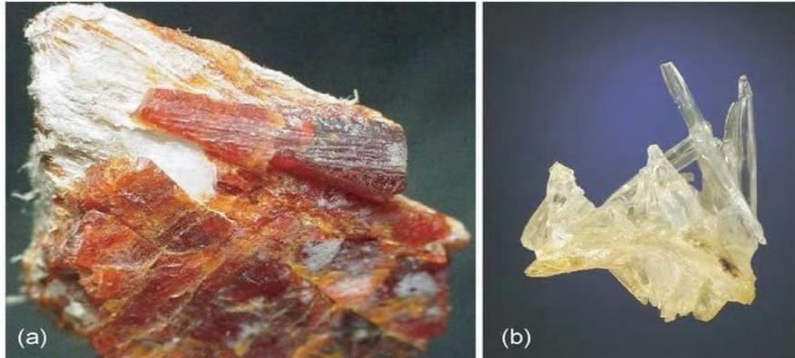
**Figure I.2.** Photographies de (a) un cristal de zincite orange et (b) un cristal d'oxyde de zinc synthétique.
