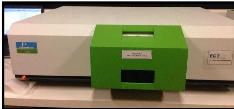
**Figure II.16.** Spectromètre de luminescence Perkin Elmer LS 55.
