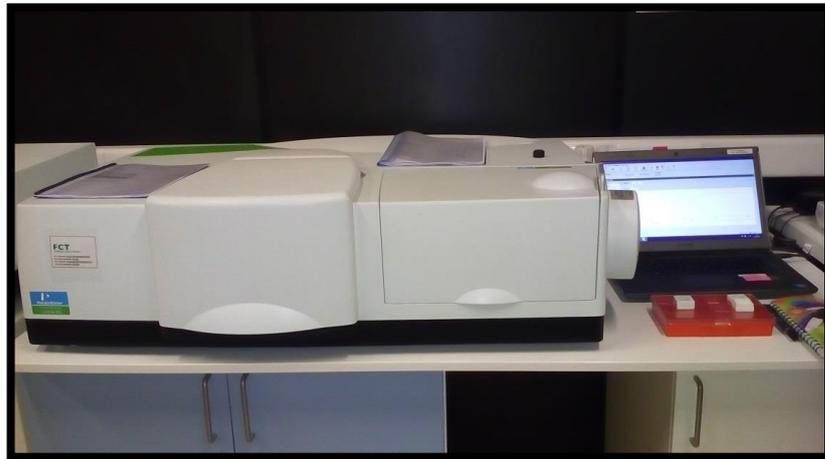
*Figure II.13. Spectrophotomètre UV-Vis à double faisceau.*
