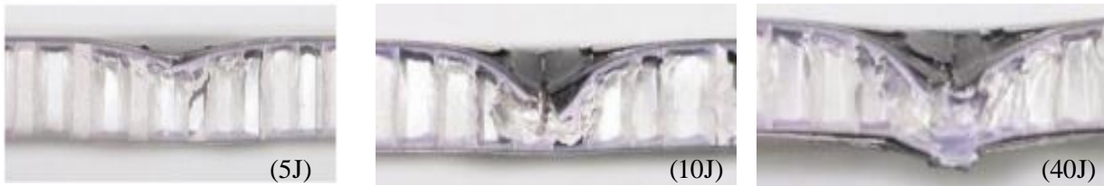
Fig 2.18: Morphologie typique d'endommagement d'impact dans les essais d'impact à faible vitesse [21]
