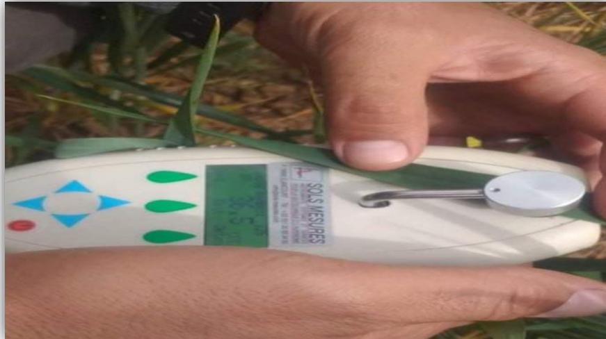
**Figure 21.** Mesure de la teneur en chlorophylle à l'aide d'un **CHLOROPHYLLE-METRE CCM 200 plus**
